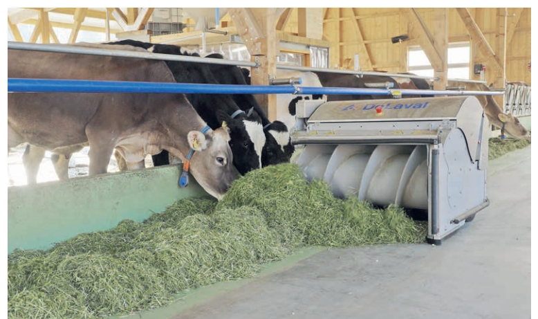
Der OptiDuo frisst das Futter sechs bis acht Mal pro Tag auf und ermöglicht somit eine hohe Grundfutteraufnahme.
